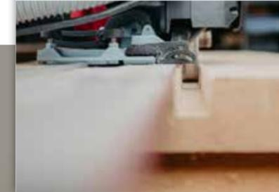
Con la fresa para ranuras regulable, disponible como accesorio especial, se pueden fresar ranuras de forma rápida y efectiva, por ejemplo, para cables de alimentación.
