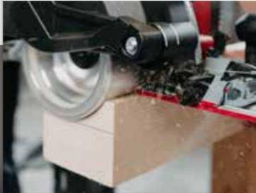
La potencia concentrada y la gran fuerza de arrastre de la NFU 50 permiten fresados de 60 mm de anchura y 50 mm de profundidad.
